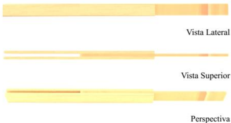
Figura 2 – Esquema de emenda das barras.
